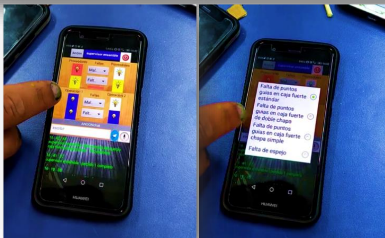
Fig. 3. Señales Andon, utilizadas en cada estación de trabajo
